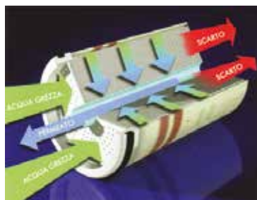
Schema di flusso della membrana osmotica.
