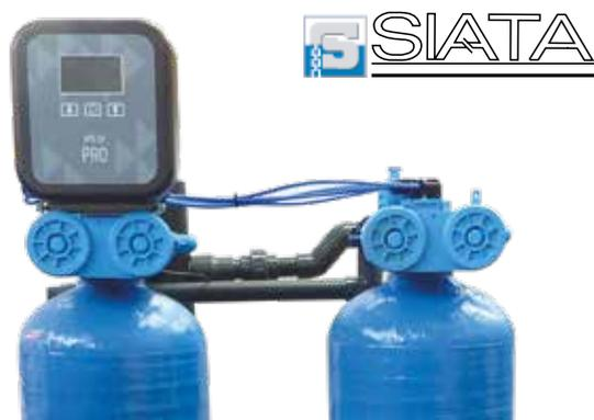
Addolcitori DUPLEX con valvole Siata e timer SFE EV. Rigenerazione a volume. Ampia possibilità di determinare le ore di rigenerazione e la durata dei cicli. Gli addolcitori con valvola 132, 230 e 250 sono forniti con valvola montata in testa bombola e distribuzione con funghetto. Completi di tino salamoia, attacchi E/U e resine cationiche di grado alimentare (fornite in sacchi a partire dal DX100)
