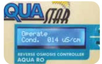
Programmatore elettronico con conduttivimetro per il controllo della qualità del permeato.
