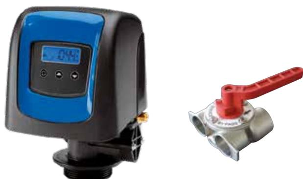
Addolcitore doppio corpo con valvola a volume Fleck 5800 SXT, completo di by pass inox e regolatore di durezza. Display LCD, con possibilità di determinare i giorni e gli orari di rigenerazione e di variare i tempi dei cicli rigenerativi. Possibilità di impostare una rigenerazione forzata ogni 4 gg. Completo di tino salamoia.
