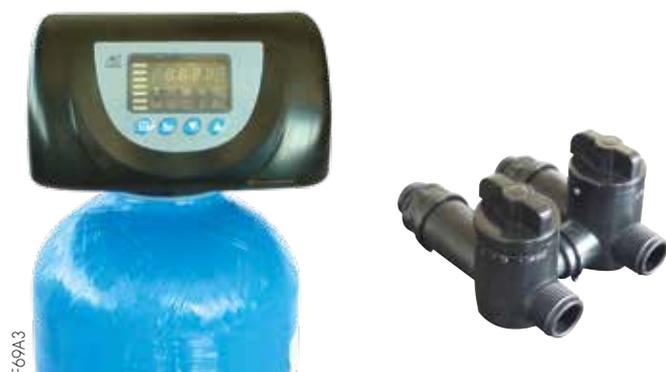
Addolcitori doppio corpo con Runxin F69 elettronica completa di display LCD, rigenerazione volumetrica in controcorrente. La valvola F69 eroga acqua non trattata durante la rigenerazione. Microswitch ausiliario e by pass compresi nella fornitura.
