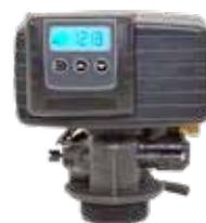
Serie SI con valvole Siata 132, 230 o 250 e programmatore elettronico SFE a volume/tempo. Il sofisticato timer Siata SFE può effettuare la rigenerazione a volume/tempo, a volume puro e ad intervalli regolari di ore. Possibilità di impostare l'allarme mancanza sale e di programmare una rigenerazione forzata e di cambiare i tempi delle fasi di rigenerazione delle resine. Entrando nel menu avanzato sono visualizzabili le statistiche relative al funzionamento storico dell'impianto.
