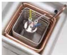
Impianti dotati di sistema di raffreddamento a BANCO DI GHIACCIO con 2 serpentine immerse in una vasca d'acqua. La serpentina in rame ghiaccia l'acqua contenuta dentro la vasca all'interno della quale c'è la serpentina inox dove scorre l'acqua da bere da raffreddare.
