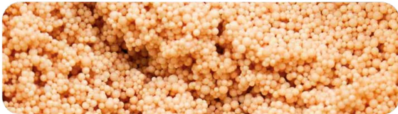
Resina chelante con acido iminodiacetico debolmente acido  $[-CH_2N(CH_2COOH)_2]$  all'interno di un copolimero di stirene/DVB con una speciale struttura macroporosa. Questo prodotto è in grado di fissare e chelare uno o più cationi specifici anche in soluzioni ad alta concentrazione.
