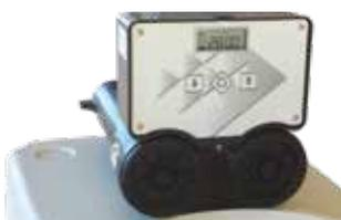
Cabinato con valvola Siata 132, timer SFE. Rigenerazione a volume, volume/tempo, ad intervalli di ore o per impulso esterno. Ampia possibilità di determinare giorni, ora di rigenerazione e durata dei cicli e di impostare una rigenerazione forzata ogni 4gg.
