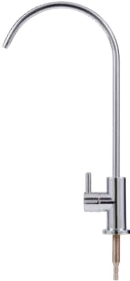
Rubinetto ad una via a leva. Finitura cromata a specchio. Attacco con codolo da 1/4". Materiale di costruzione: ottone, ottone cromato e beccuccio in acciaio inox (canna erogazione).
