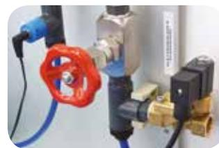
Valvola a spillo inox ed elettrovalvola di flussaggio.
