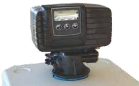
Addolcitore cabinato con Fleck 5600 SXT, completo di by pass inox e regolatore di durezza. Rigenerazione a volume, volume/tempo. Display LCD, con possibilità di determinare i giorni, le ore ed i tempi dei cicli rigenerativi ed una rigenerazione forzata ogni 4 gg.
