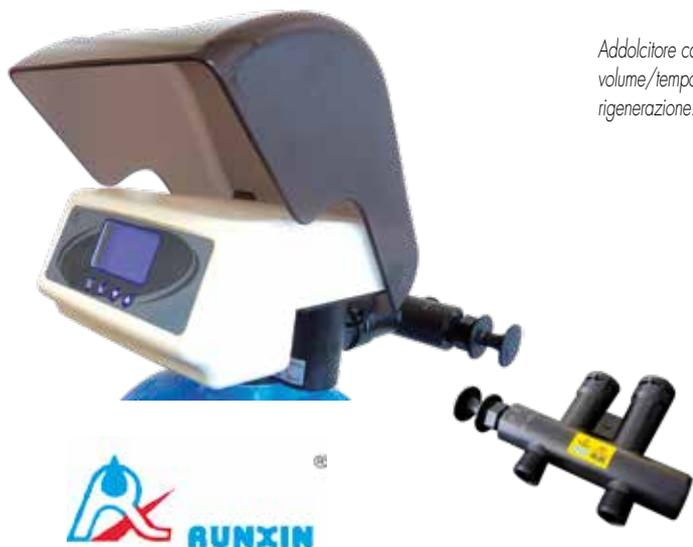
Addolcitore cabinato con Runxin F79 completo di display LCD e rigenerazione in eicorrente. Rigenerazione a volume o volume/tempo. Microswitch ausiliario e by pass compresi nella fornitura. La valvola eroga acqua non addolcita durante la rigenerazione.
