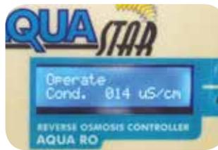
Programmatore elettronico con conduttivimetro per il controllo della qualità del permeato.
