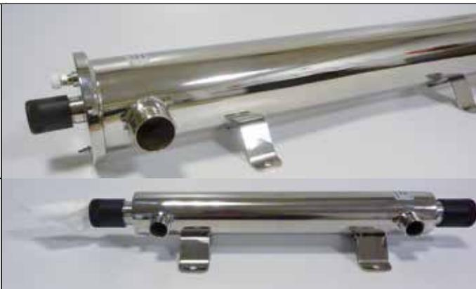
Pressurizzare e controllare che non vi siano trafileamenti dagli o-ring. Verificare con della carta assorbente che non vi sia acqua all'interno della guaina di quarzo. In caso affermativo controllare che non vi sia dello sporco sulle sedi degli o-rings o che l'o-ring non sia pizzicato o ruotato.
