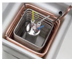
Impianti dotati di sistema di raffreddamento a BANCO DI GHIACCIO con 2 serpentine immerse in una vasca d'acqua. La serpentina in rame ghiaccia l'acqua contenuta dentro la vasca all'interno della quale c'è la serpentina inox dove scorre l'acqua da bere da raffreddare. Con questo sistema è possibile refrigerare notevoli quantità d'acqua in continuo per applicazioni professionali come bar e ristoranti.
