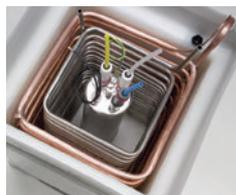
Impianti dotati di sistema di raffreddamento a BANCO DI GHIACCIO con 2 serpentine immerse in una vasca d'acqua. La serpentina in rame ghiaccia l'acqua contenuta dentro la vasca all'interno della quale c'è la serpentina inox dove scorre l'acqua
