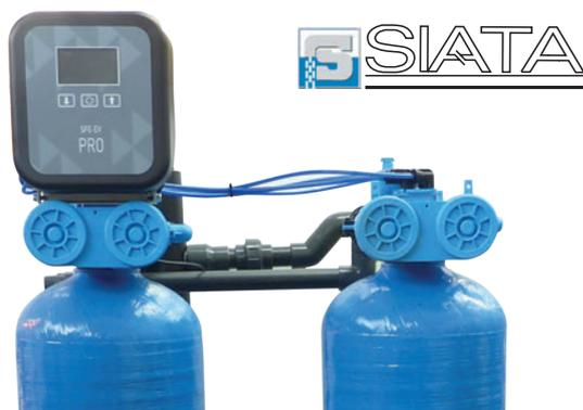
Addolcitori DUPLEX con valvole Siata e timer SFE EV. Rigenerazione a volume. Ampia possibilità di determinare le ore di rigenerazione e la durata dei cicli. Gli addolcitori con valvola 132, 230 e 250 sono forniti con valvola montata in testa bombola e distribuzione con funghetto; gli addolcitori con valvola 360 sono con valvola laterale e distribuzione a raggiera. Completati di tino salamoia, attacchi E/U e resine cationiche di grado alimentare (fornite in sacchi a partire dal DX100)
