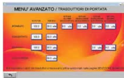
Il K-Factor da inserire è fornito direttamente dal costruttore ed è legato a fattori standard di utilizzo dello strumento. Per tale motivo potrebbe essere necessario tarare il trasduttore di portata al fine di determinare le reali portate del permeato, concentrato e ricircolo.
