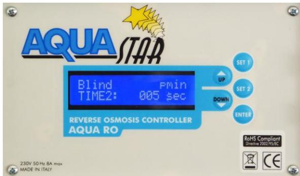
TIME2: è il tempo in secondi di disabilitazione del pressostato di minima dopo la partenza della pompa (di default 5 secondi)
