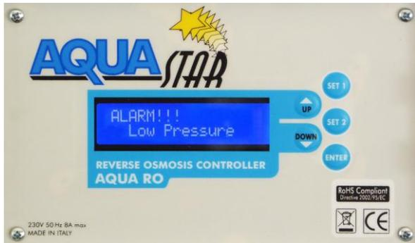
2. *Allarme di bassa pressione. Si innesca per mezzo del pressostato di minima. L'impianto si ferma immediatamente ed effettua 3 tentativi di ripartenza automatici a distanza di alcuni minuti (vedi Menù di programmazione TIME 5);*
