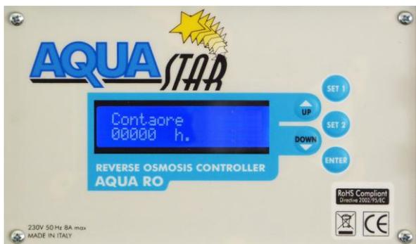
Per verificare le ore di funzionamento dell'impianto RO premere contemporaneamente i tasti SET1 e SET2 quando il quadro è in produzione. In questo modo vengono visualizzate le ore di funzionamento della pompa ad alta pressione; per uscire da questa modalità basta premere SET2.
