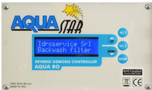
6. Fermo impianto per contro lavaggio/rigenerazione addolcitore/filtro di pretrattamento. Si innesca per un contatto proveniente dall'apparecchiatura a monte (quando va in contro lavaggio). L'impianto si ferma immediatamente e riparte automaticamente appena scompare il segnale;
