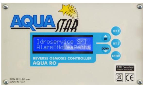
7. Allarme mancanza prodotti chimici (ad es. antiscalante). Si innesca per mezzo del galleggiante degli additivi chimici. L'impianto si ferma immediatamente; per riavviarlo agire sul galleggiante.
