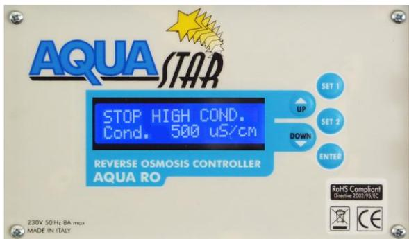
4. *Allarme alta conducibilità permeato (con set point regolabile). Si innesca per mezzo del conduttivi metro del permeato. A seconda dell'opzione indicata sul menù di programmazione COND-ALARM, l'impianto si ferma, oppure continua a lavorare indicando l'allarme sul display;*
