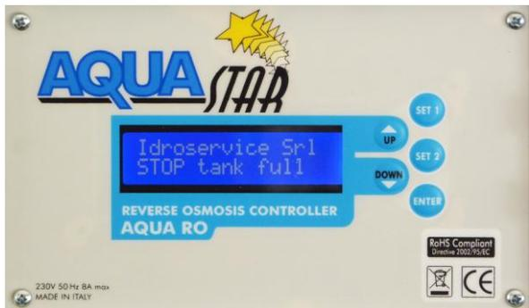
1. Fermo impianto per serbatoio permeato pieno. Si innesca con l'apposito galleggiante. L'impianto effettua un flussaggio e poi si mette automaticamente in stand/by. Quando il galleggiante indica che il serbatoio è vuoto l'impianto riparte automaticamente effettuando prima un flussaggio.
