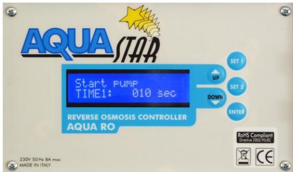
TIME1: è il tempo in secondi che intercorre fra l'apertura della EV1 (elettrovalvola di ingresso) e la partenza della pompa HP (di default 10 secondi)
