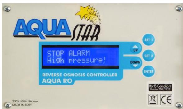
3. *Allarme di alta pressione. Si innesca per mezzo del pressostato di massima. L'impianto si ferma immediatamente; per riavviarlo agire manualmente sull'interruttore magnetotermico a monte del quadro;*
