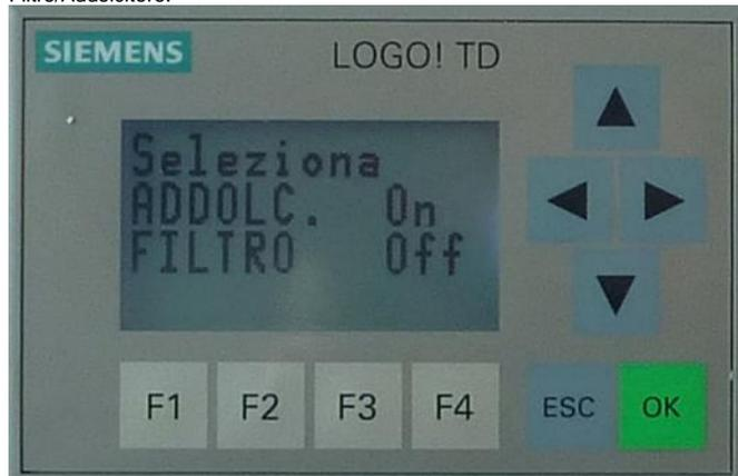
Premere **ESC** fino all'apparire del cursore mobile sulla linea del parametro **ADDOLC.**, premere **OK** si vedrà lampeggiare la lettera **O** e selezionare **On** con la freccia **SU** ed infine premere **OK**. se si vuole che il programmatore gestisca le fasi di rigenerazione di un addolcitore. Ripetere l'operazione su **FILTRO** e selezionare **On** se si vuole che il programmatore sia idoneo a gestire le fasi di contro lavaggio di un filtro. Premere **OK** per evidenziare il parametro.
