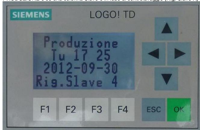
Se la programmazione impostata di fabbrica non è idonea al sistema in cui è installata la macchina, diviene necessario modificare alcuni parametri. Per entrare nella programmazione premere contemporaneamente i tasti F3 ed F4. In tal modo si entra nella modalità che consente di modificare le impostazioni della centralina. La scansione delle pagine alla ricerca del parametro da cambiare si effettua con il tasto F3.
