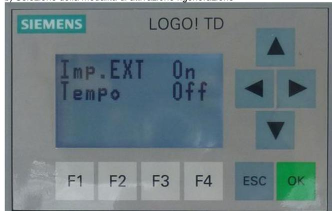
Questa pagina consente di scegliere la modalità con cui viene attivato il contro lavaggio/rigenerazione dell'apparecchiatura Master. Terminato il contro lavaggio/rigenerazione sul Master inizieranno immediatamente dopo a cascata le rigenerazioni sugli Slaves. Per selezionare premere i tasti ESC + + OK e con le frecce evidenziare la modalità che interessa su On e l'altra su Off, infine premere OK + ESC per confermare. Premere F3 per passare alla programmazione successiva.
