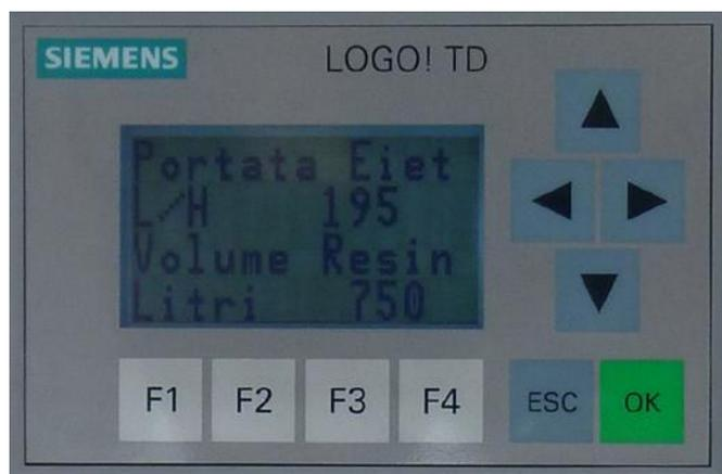
Per indicare la portata di aspirazione della salamoia dell'eiettore, nonché i litri di resina contenuti nel serbatoio premere ESC ed OK e con le frecce indicare il valore di portata dell'eiettore (di default 200 l/h). Premere OK e con ► spostare il cursore sulla quantità (in Litri) delle resine dell'addolcitore. Premere OK e con le frecce impostare il valore. Terminata l'impostazione dei giorni, premere OK+ESC per confermare i dati. Premere F3 per passare alla pagina successiva.
