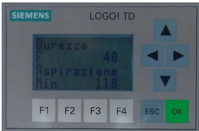
Questa pagina consente di impostare il valore di durezza totale dell'acqua da addolcire. Premere ESC ed OK e con le frecce impostare il valore di durezza in gradi francesi °F. Premere OK per confermare il valore impostato ed una freccia per uscire.
