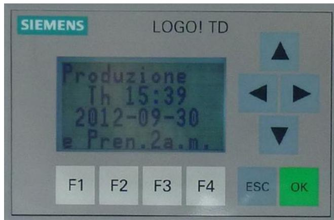
Per ANNULLARE una rigenerazione manuale DIFFERITA alle 2 di notte premere per 2 volte in rapida sequenza il tasto **F1**. Nel display scomparirà la scritta della rigenerazione prenotata.
