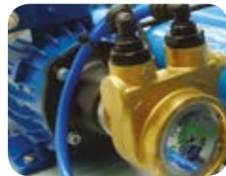
Gruppo di pressurizzazione con pompa a palette.
