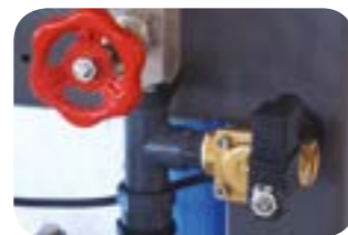
V. a spillo inox 316 + E.V. flussaggio.
