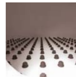
Piastra forata con ugelli filtranti (Addolcitori RPP)
