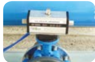
E.V. flussaggio acqua pulita (opzionale).
