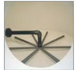
Distribution interne avec collecteur à crépines
