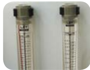
Fluxmètres pour la lecture du concentrat et du perméat.
