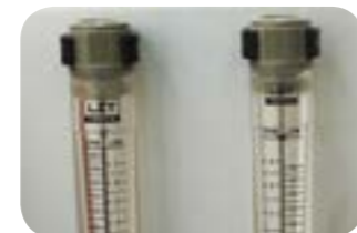
Fluxmètres pour la lecture du concentrat et du perméat.
