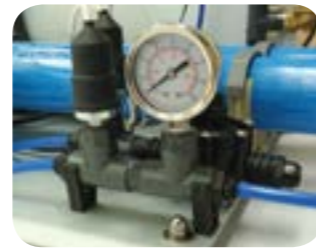
Groupe de pressostats; minimum, maximum et manomètre.
