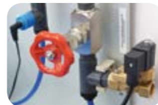
Robinet à pointeau en inox 316 et électrovanne de fluxage.
