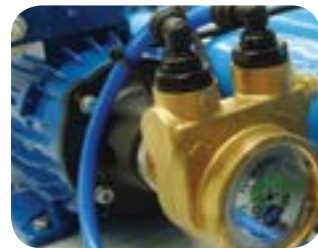
Groupe de pressurisation avec pompe à palettes.
